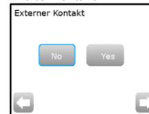
Für optimale Regelung muss das Gerät wissen, ob die Last direkt ans Thermostat (Standardfall) oder über einen externen Kontakt angeschlossen ist. Betätigen Sie „Ja“ oder „Nein“ und wechseln Sie zum nächsten Menü.
